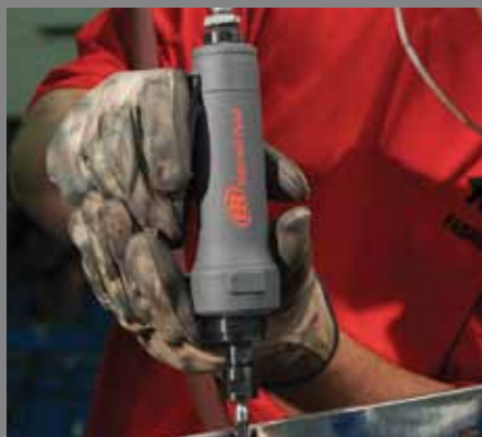
Pulizia e levigatura delle saldature
