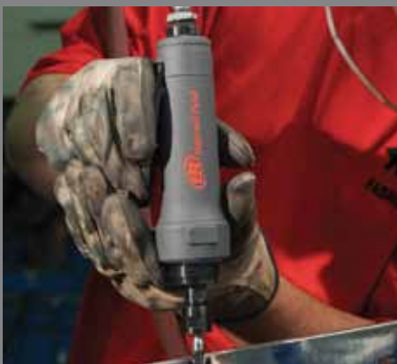
Säubern und Glätten nach Schweißarbeiten
