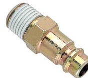
IB6NMC2 88103015 Conector Serie IBN/IBS, conexión macho 1/4", paso 6 mm (ISO6150B / MIL-C4109)
