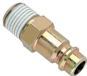
77NMC3 88104088 Stecknippel Baureihe 7N7/7S7, Außengewinde 3/8", Bohrung 7,2 mm (EURO 7,2 - 7,4)
