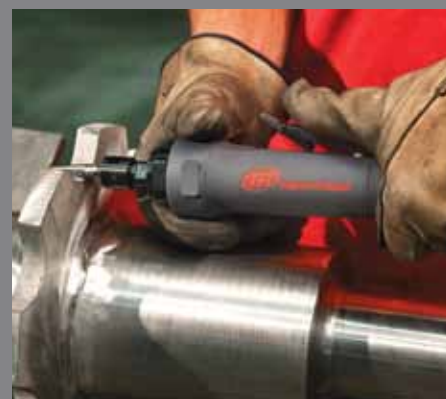
Desbarbado y acabado de los cantos
