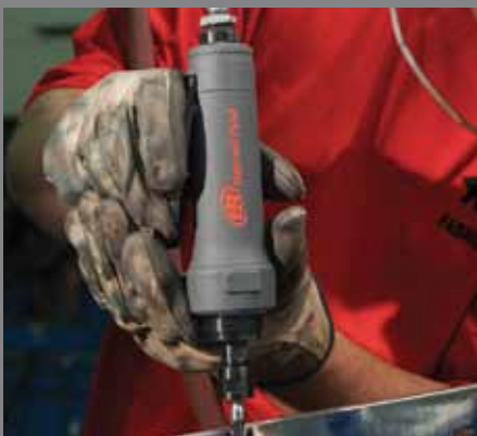
Limpeza y alisado tras la soldadura
